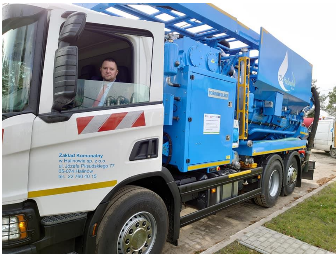
Fot. 208. Specjalistyczny pojazd ssąco-płuczący przeznaczony do ciśnieniowego czyszczenia sieci kanalizacyjnych
